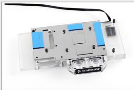
3.在相应位置贴好导热硅脂条
