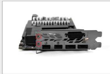
拿下散热器，拆除图中标红位置螺丝
